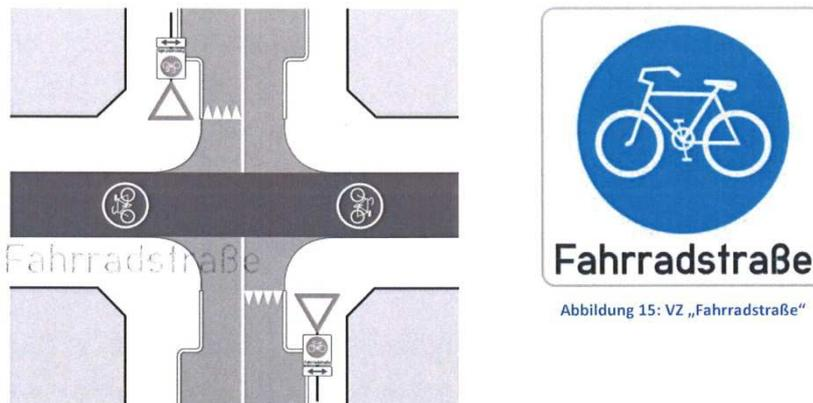
Abbildung 14: Systemskizze einer Kreuzung mit einer Fahrradstraße
